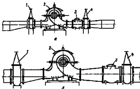
6. Схемы установки трубопроводной арматуры на всасывающей (подводящей) и напорной линиях насоса
